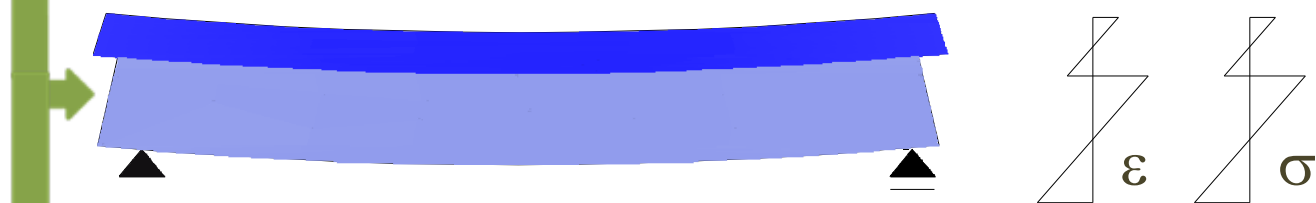
Interface sem transferência de tensões de cisalhamento
